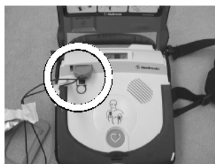
Figure 7. La fiche de l'électrode (entourée d'un cercle) se détache facilement pendant l'utilisation de l'appareil Medtronic.
